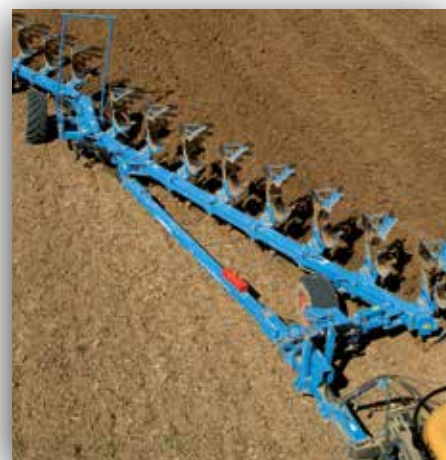
Mellső támkerék az eke munkaszélességén belül
