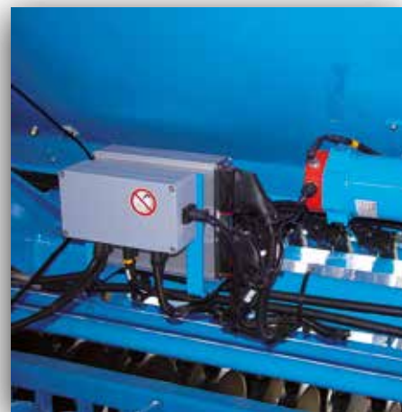
Elektromos vetőtengely meghajtás
