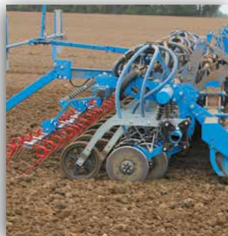
A dupla-tárcsás OptiDisc csoroszlya hidraulikus hogy 70 kg csoroszlyák nyomásának
