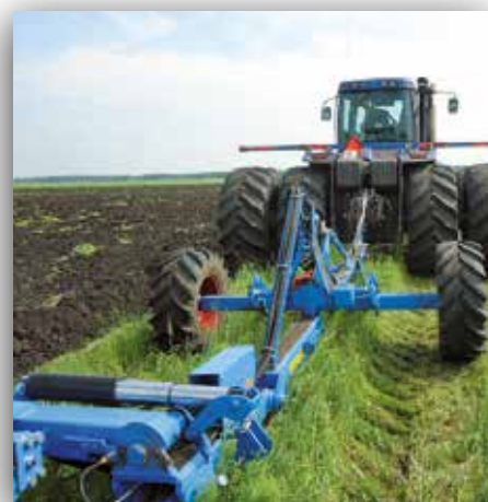
Kapcsoló alváz hidraulikus hárompont nélküli traktorokhoz
