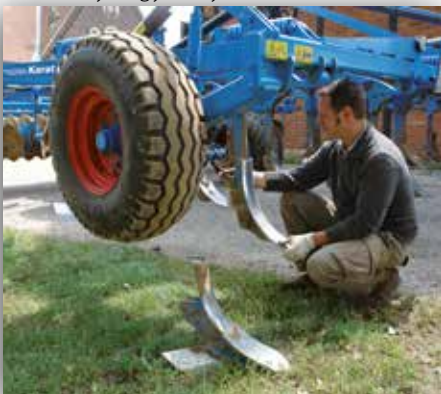
Művelő eszközök gyors és egyszerű cseréje
