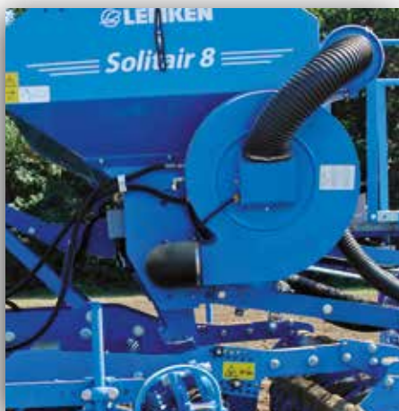
Hidraulikus meghajtott ventilátor
