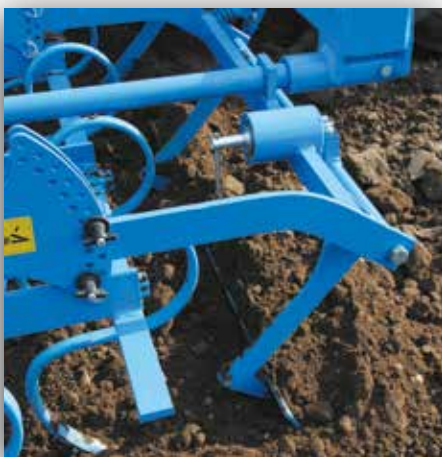
Multifunkcionális simítólemez működés közben
