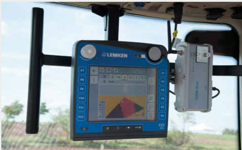
A CCI terminál a traktor fülkéjében
