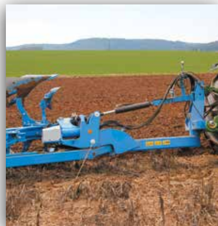
Súlyáthelyező rendszer a Diamant 12-n
