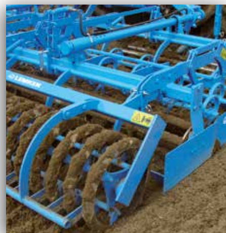
Simítólemezek hidraulikus átállítása
