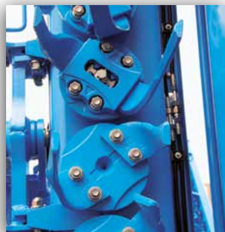
Fogak gyorscserélő rendszere
