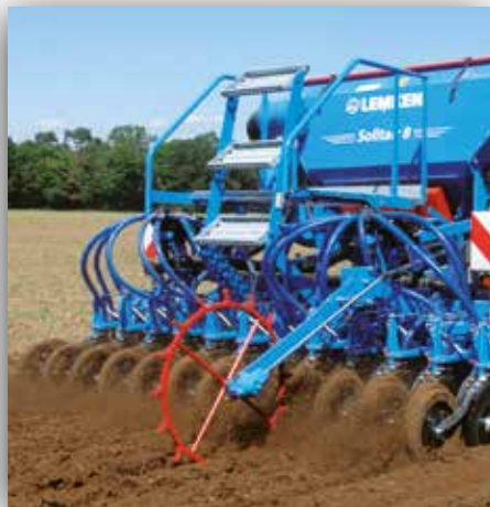
A jeladó kerék a munkaszélességben halad
