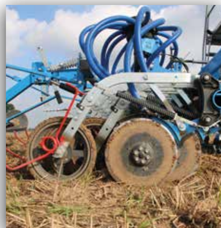
A dupla-tárcsás OptiDisc csoroszlya mechanikus hogy 45 kg csoroszlyák nyomásának
