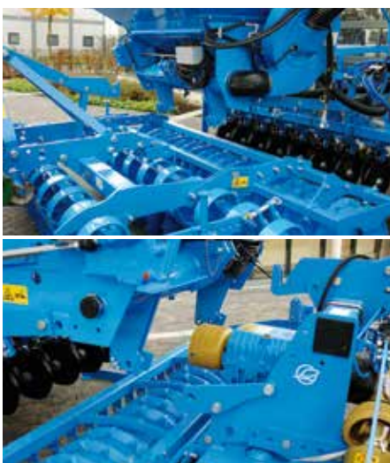
A Heliodor rövidtárcsán (fent) és a Zirkon forgóboronán (lent) lévő univerzális csatlakozás biztosítja azt, hogy a vetőgépet gyorsan át lehet szerelni az egyik talajművelő-eszköztől a másikra.
